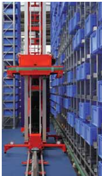
Equipo automatizado transelevador
