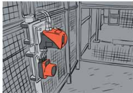
Sistema de seguridad de obstrucción de pasillos en el interior del transelevador
