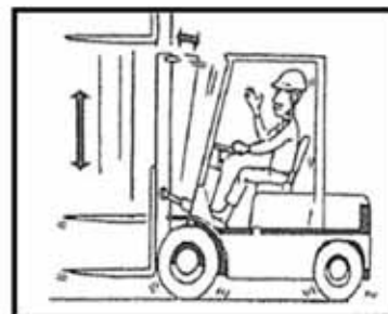
Recorrido e inclinación del mástil
