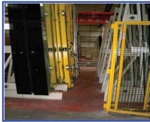
Pasillos entre caballetes de almacenamientos fijos
