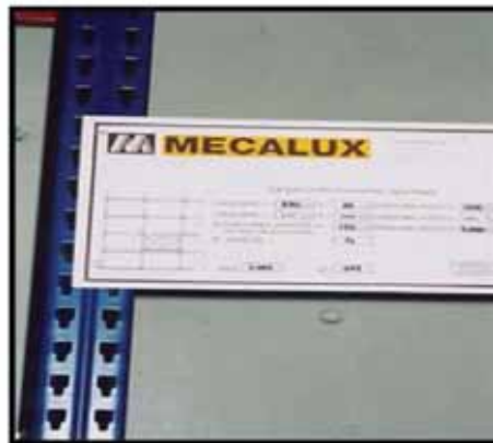
Identificación de la carga en la estantería
