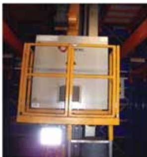
Puesto de operador de transelevador
