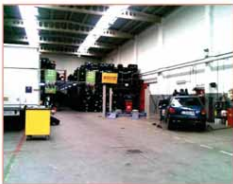
Altura máxima en almacenamiento libre 3 m
