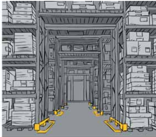
Túnel de paso
