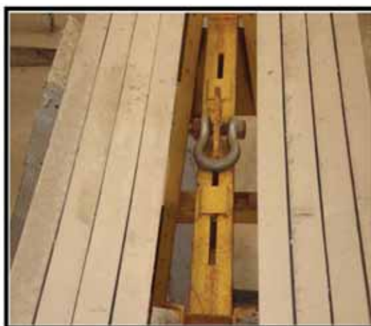
Caballote transportable mediante orejeta de elevación y grillete
