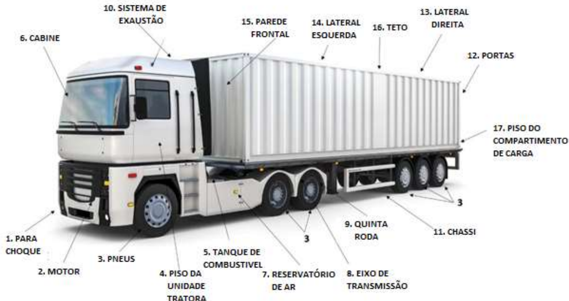
Fig. 17 – Inspeção dos 17 pontos dos veículos de carga.
